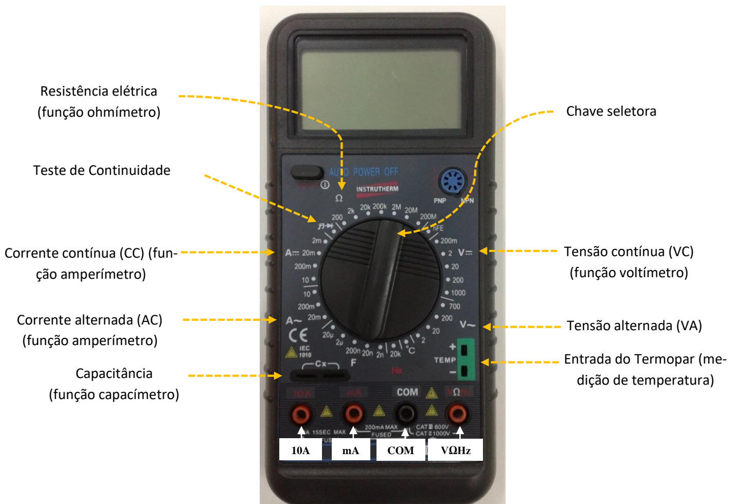
Figura 1. Multímetro e suas principais funções.
