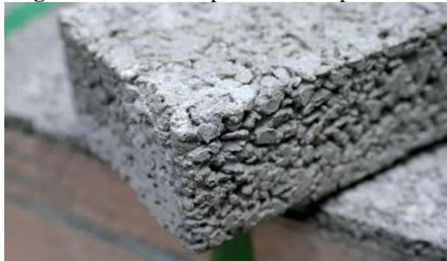
Figura 10- Concreto permeável ou poroso.
