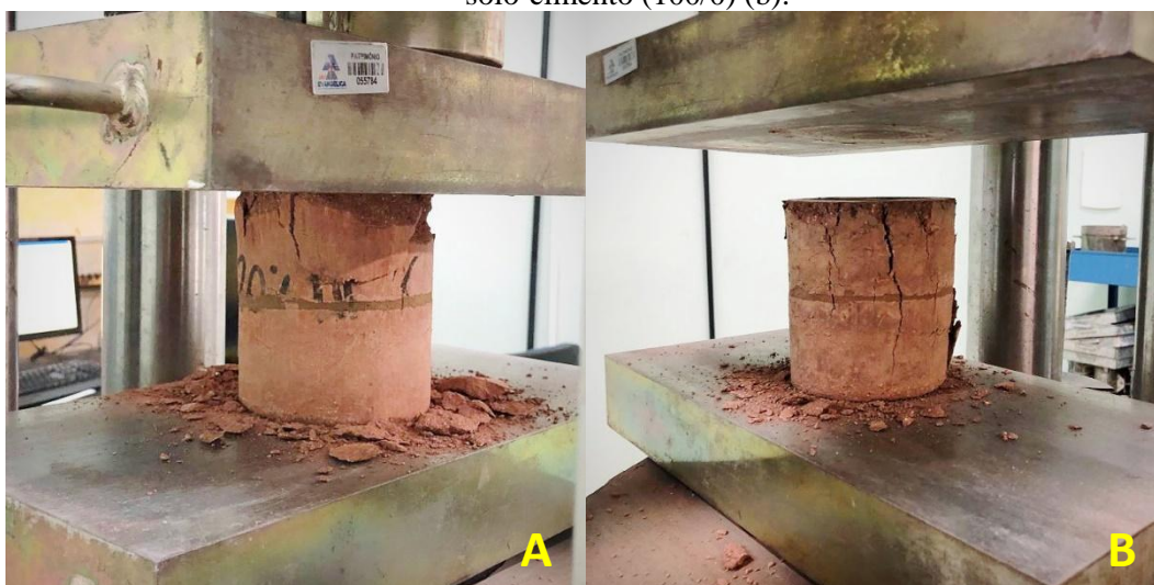
Figura 4 - Fratura dos corpos de prova após ensaio de compressão: solo-cimento (80/20) (a) e solo-cimento (100/0) (b).
