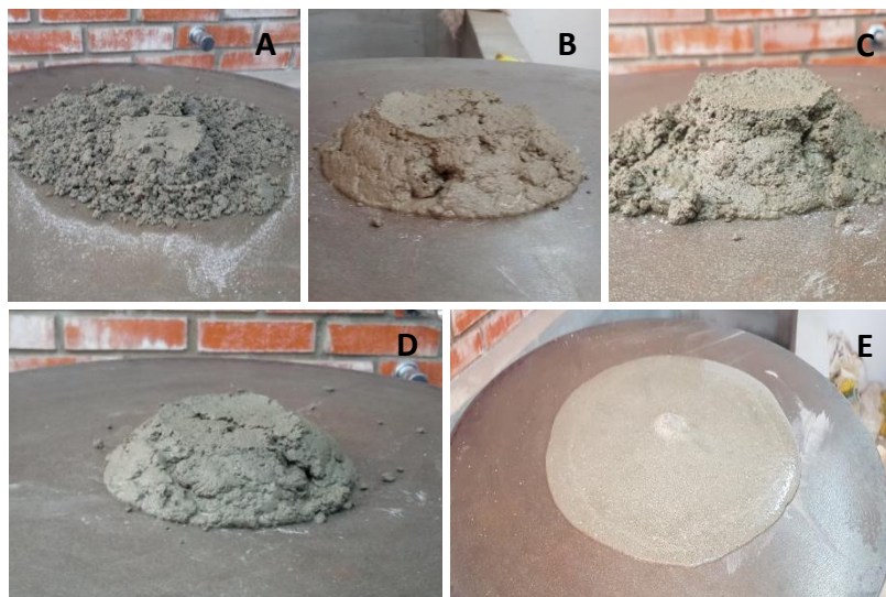
Figura 4 – Ensaio de abatimento. ACON (a), ACAL (b), AVED (c), AL01 (d), AL08 (e).
