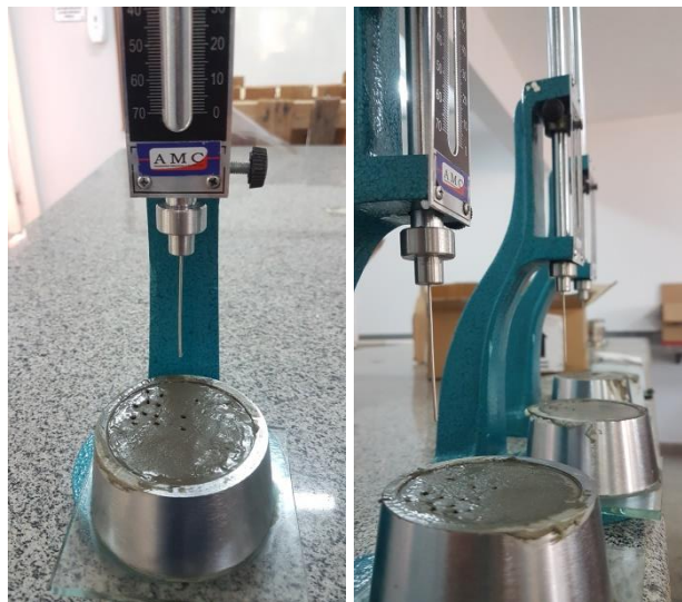
Figura 3 – Ensaio na pasta de cimento com aparelho de Vicat.
