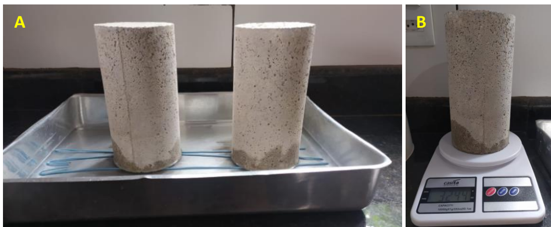
Figura 5 – Ensaio de absorção de água por capilaridade (a) e a determinação da massa (b).
