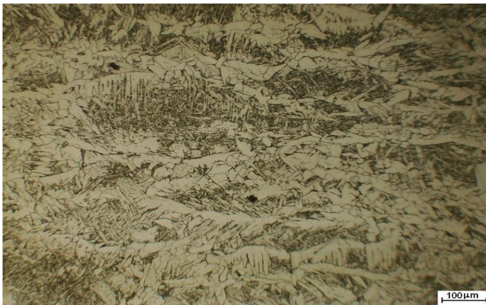
Figura 17 - Metalografia do local de solda do corpo de prova soldado via processo TIG.
