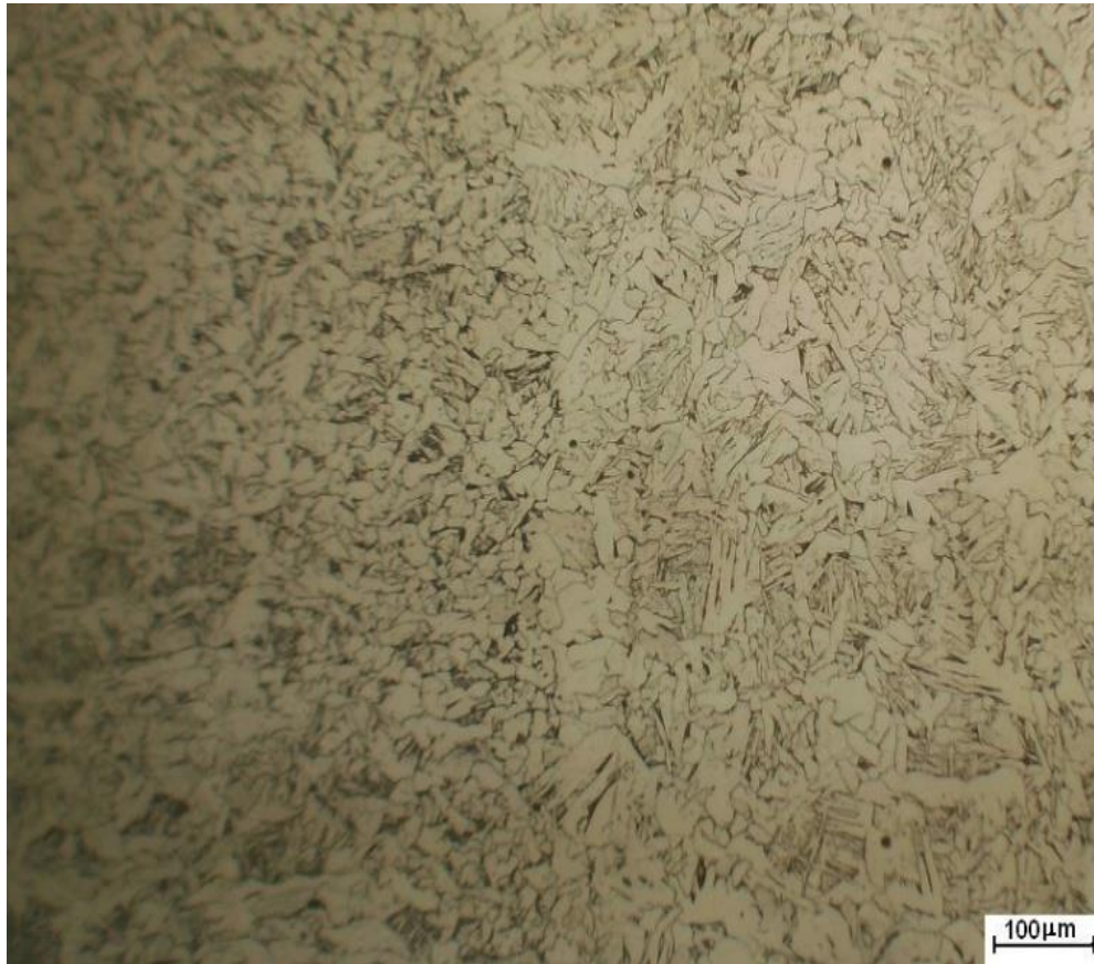
Figura 15 - Metalografia da ZTA do corpo de prova soldado via processo TIG.
