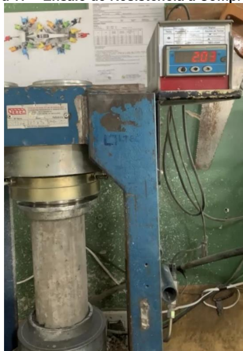
Figura 17 – Ensaio de Resistência à Compressão.
