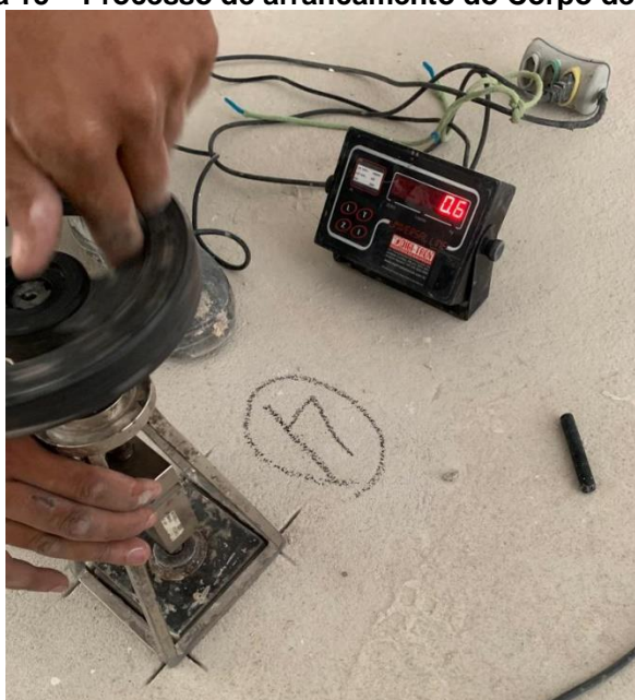
Figura 15 – Processo de arrancamento do Corpo de Prova.
