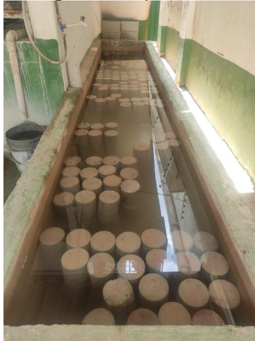
Figura 16 – Tanque de Cura.
