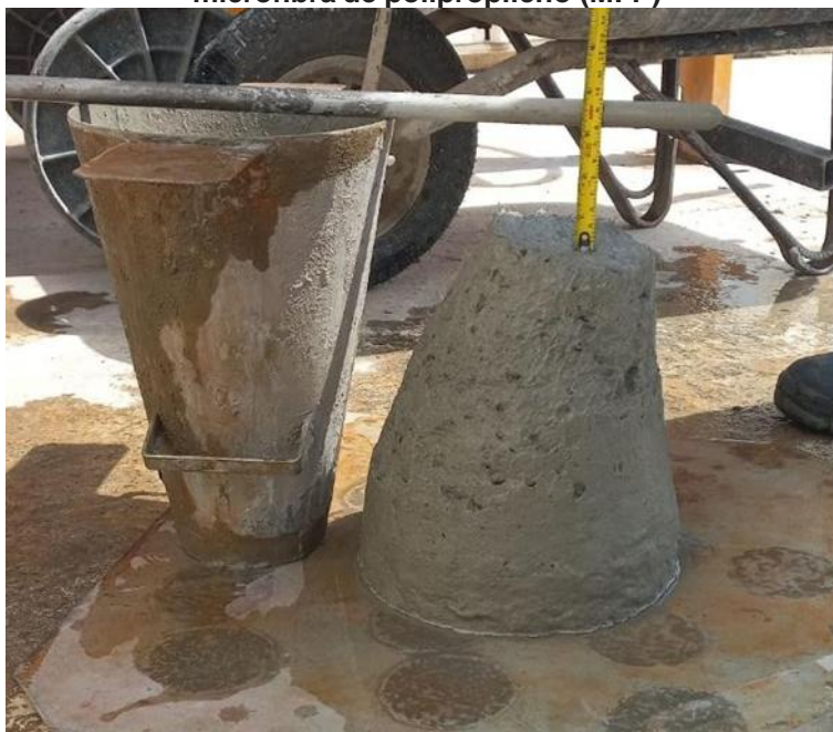
Figura 13 – Slump Test concreto com adição de 1% microfibras de polipropileno (MFP)
