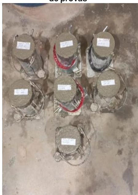
Figura 8 – Modelagem dos corpos de provas
