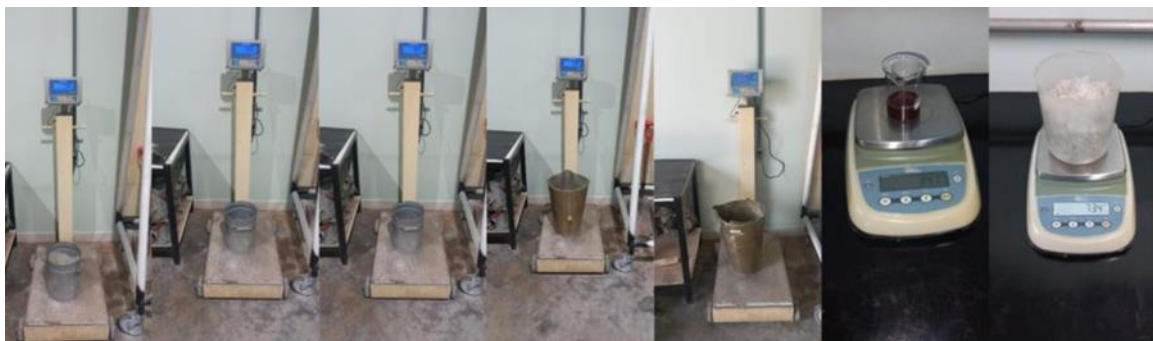
Figura 5 – Pesagem dos materiais selecionados para o concreto
