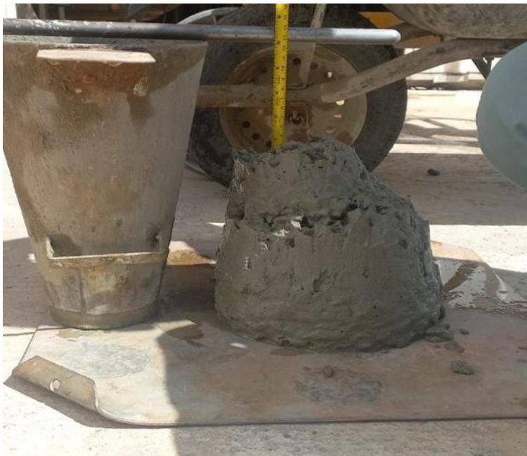
Figura 12 – Slump Test do concreto referência
