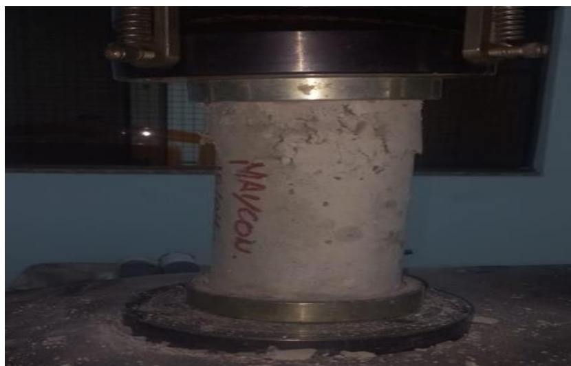
Figura 11 – Corpo de prova ensaio de resistência à compressão em laboratório
