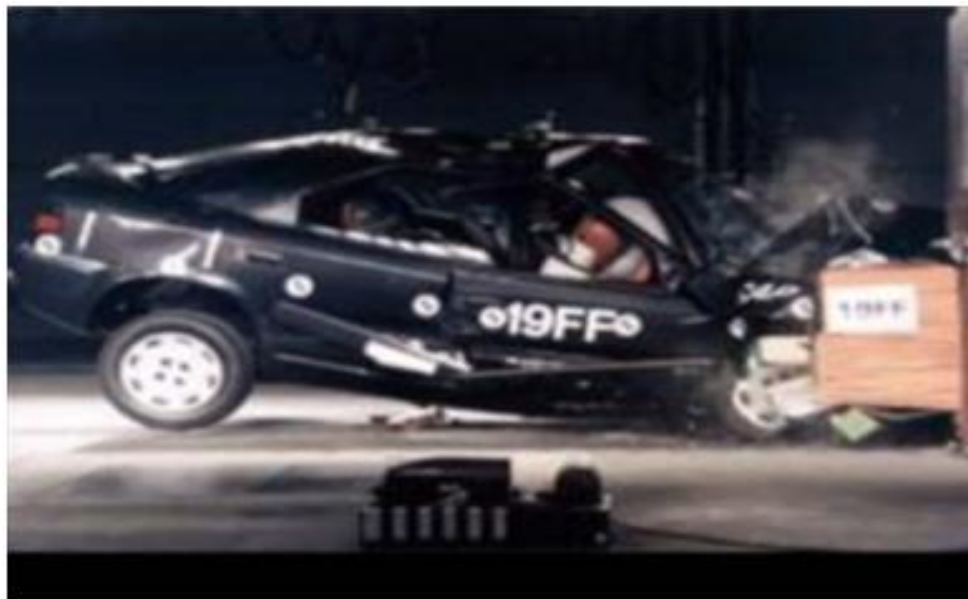
Figura 02: Impacto frontal a 64 km/h contra uma barreira deformável com 40% de sobreposição – Veículo 1997.
