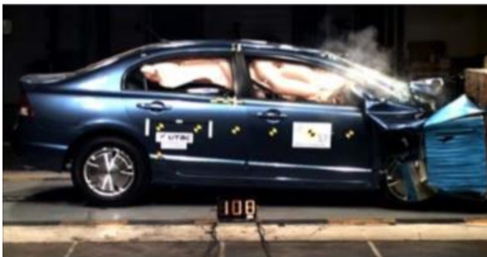
Figura 03: Impacto frontal a 64 km/h contra uma barreira deformável com 40% de sobreposição – Veículo 2007.
