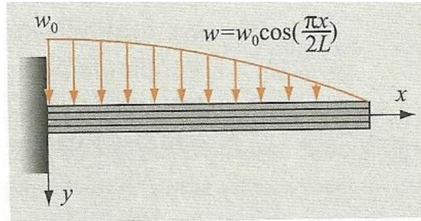
Onde  $L = 3\text{ m}$  é o comprimento,  $E = 70\text{ GPa}$  é o módulo elástico,  $I = 52,9 \cdot 10^{-6}\text{ m}^4$  é o momento de inércia e  $w_0 = 15\text{ kN/m}$ . Determine a posição  $x$  onde a deflexão da viga é de  $9\text{ mm}$ . Utilize o método de Secante, com precisão de  $10^{-4}$ .
