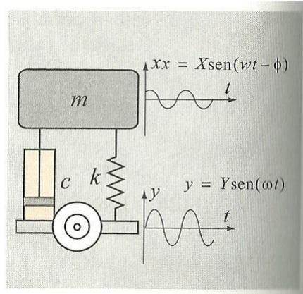
Assumindo  $m = 2000 \text{ kg}$ ,  $k = 5 \cdot 10^5 \text{ N/m}$  e  $c = 38 \cdot 10^3 \text{ N-s/m}$ , determine a frequência  $\omega$  na qual  $X/Y = 0,2$ . Encontre um intervalo que tenha apenas uma raiz utilizando o teorema da Unicidade e resolva utilizando o método de Newton. Sugestão (Reescreva a equação para que ela tenha a forma de um polinômio em  $\omega$ ).
