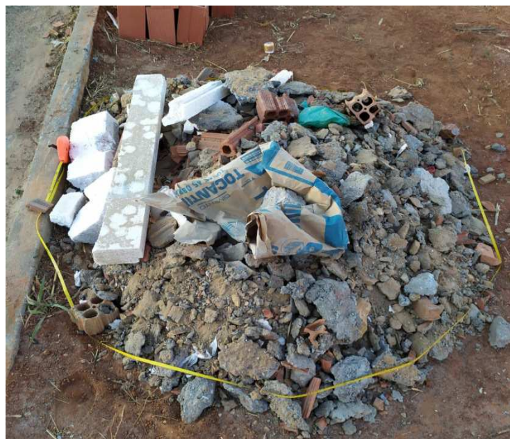
Imagem 2 - Medição de circunferência de amostra de RCC oriundos de obra residencial.
