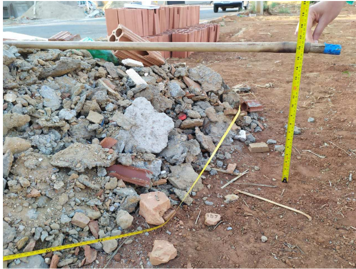
Imagem 3 - Medição de altura de amostra de RCC oriundos de obra residencial.
